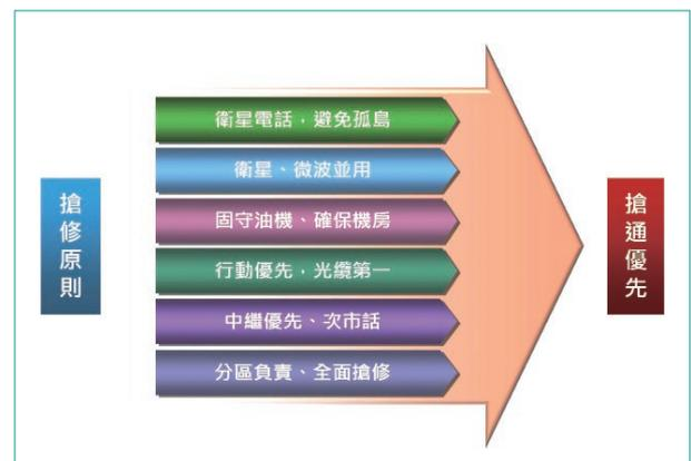
圖3 颱風過後障礙搶修與復舊階段流程圖
