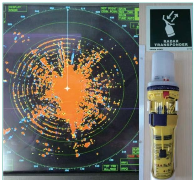
圖4 雷達詢答機 (右) 及雷達螢幕中心顯示12個同心圓
