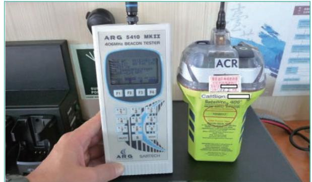
圖3 MMSI碼測試器 (左) 及緊急指位無線電示標 (右)
