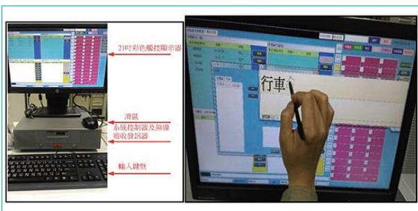
圖6 調度臺組成（左圖），手寫輸入介面（右圖）
